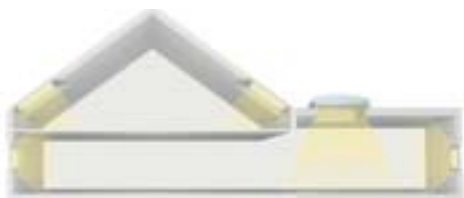
L'entrée de lumière zénithale permet de bénéficier d'une bonne luminosité tout au long de la journée.
