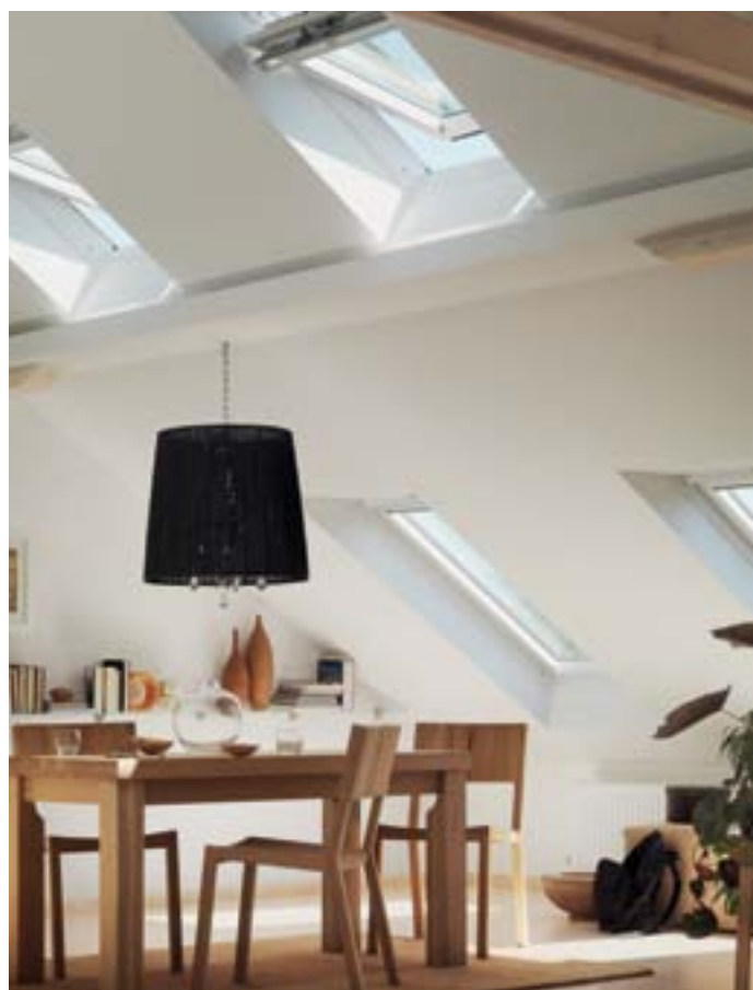
L'installation de plusieurs fenêtres en puits de lumière renforce l'efficacité de la ventilation de la maison grâce à "l'effet cheminée".
